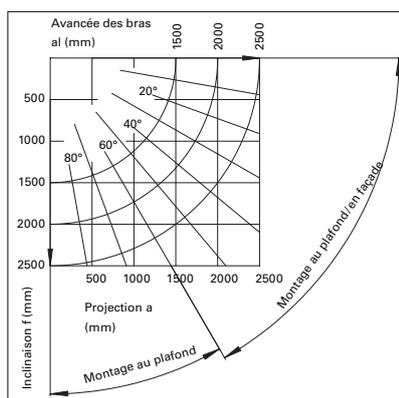
La projection dépend de l'avancée des bras et de l'angle de montage  $\alpha$ .
