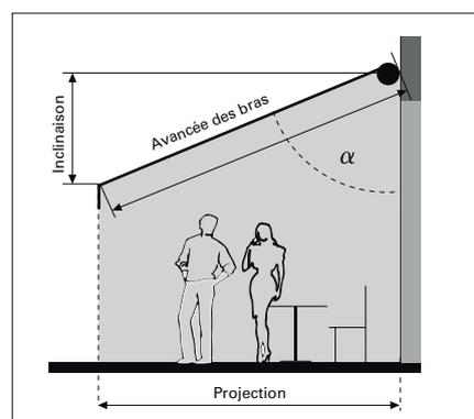
La projection dépend de l'avancée des bras et de l'angle de montage  $\alpha$
