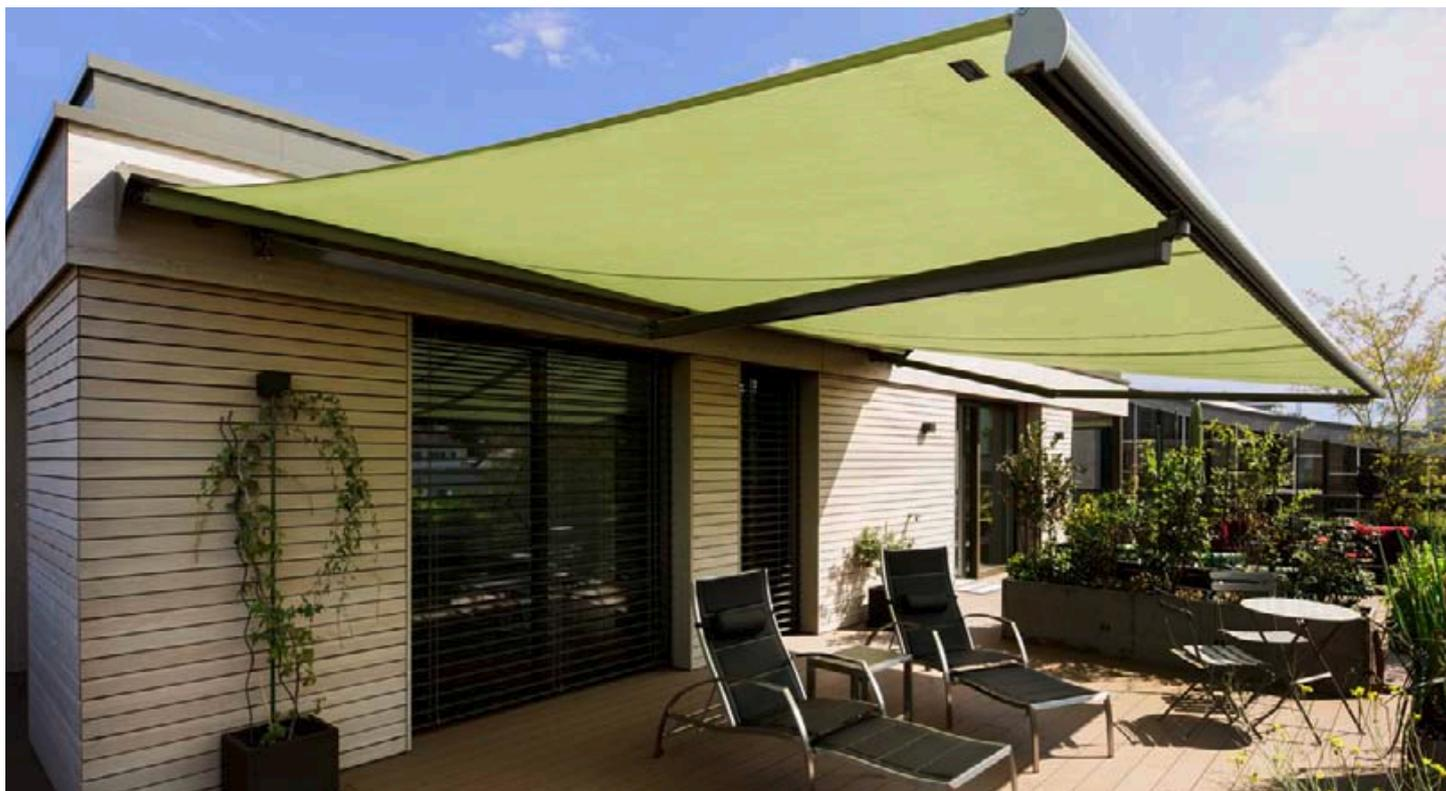
Ce store permet de couvrir de grandes terrasses allant jusqu'à 6m de largeur et 4m d'avancée (en 2 bras) grâce à une barre carrée sur laquelle sont fixés les bras, les extrémités et le tube enrouleur.
