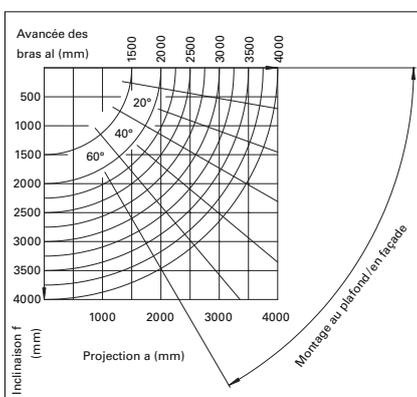
La projection dépend de l'avancée des bras et de l'angle de montage  $\alpha$ .
